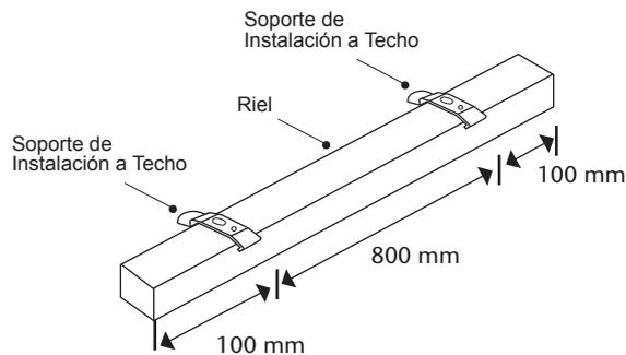
Para colocar los soportes mida 100 mm. desde los extremos de la cortina y marque con un lápiz la localización de los soportes en la pared o techo. La separación entre soportes no deberá exceder los 800 mm.
